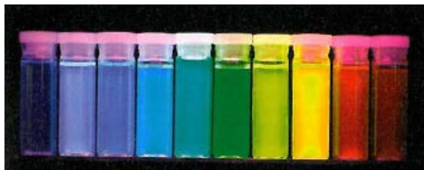
CdSe quantum dots [Niemeyer, 2005]
