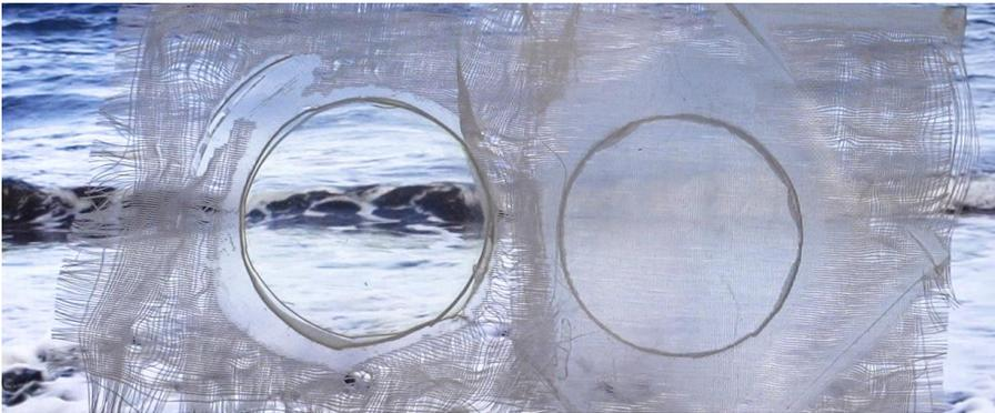
Glasfaser verstärktes Polymer, links, korrekte und rechts nicht korrekte Matrix
