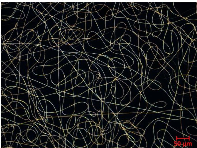
Foto: Metallisierte Fasern; © INM; frei in Zusammenhang mit dieser Meldung
