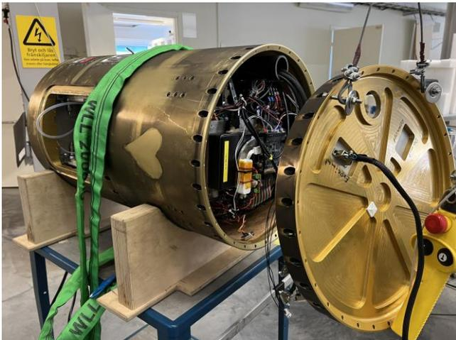
Foto: Modul zum Transport der Experimente in MAPHEUS-12
