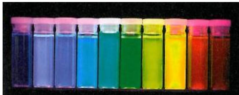
CdSe quantum dots [Niemeyer, 2005]
